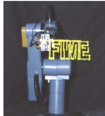
Figura 7.2.- Fotografía (a) de un artista dibujando con una lámpara y (b) del robot en movimiento realizando una figura en el aire. Ambas fotos fueron tomadas utilizando una cámara fotográfica con el obturador abierto.
